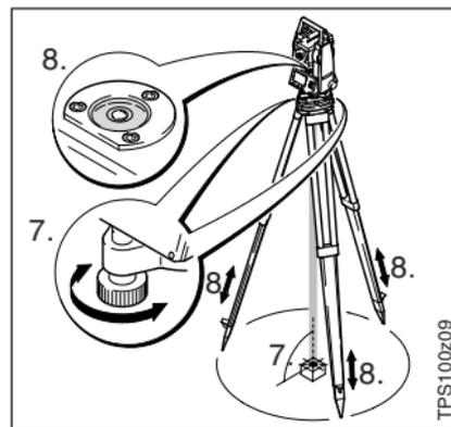
7. Con los tornillos nivelantes, centrar el rayo láser sobre el punto genau del terreno.
