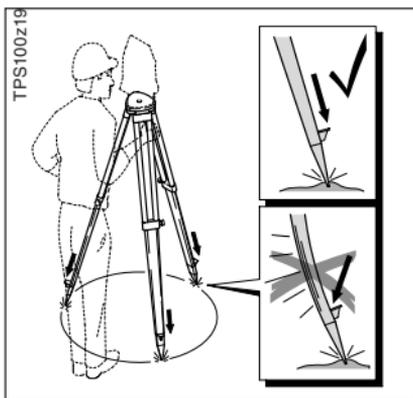
1. Aflojar los tornillos de las patas del trípode, extenderlas hasta la altura necesaria y apretar los tornillos.
