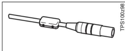
Los cables suministrados por Leica Geosystems están ya equipados con un núcleo de ferrita.
