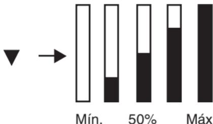
La tecla de pantalla [OK] fija la intensidad del láser indicada y termina la función.
