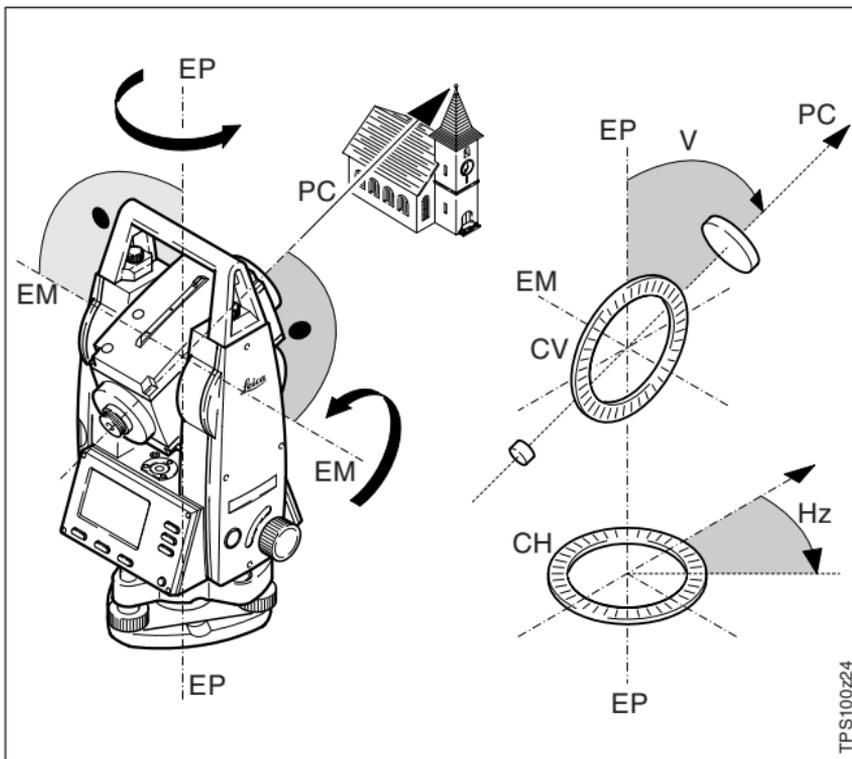
**PC = Eje de puntería/eje de colimación**
