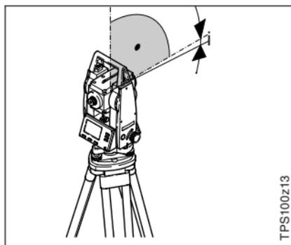
Si la línea visual es horizontal, la lectura del círculo vertical debería ser de exactamente  $90^\circ$  (100 gon). La desviación de este valor se denomina error de índice vertical ( $i$ ).
