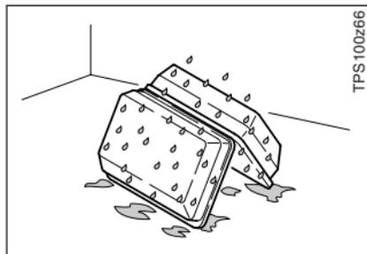
**Si el instrumento se ha mojado**, sacarlo del maletín. Secar (a temperatura máxima de 40°C/104°F) y limpiar el instrumento, los accesorios y el maletín y sus interiores de espuma. Volver a guardarlo cuando todo el equipo esté bien seco.
