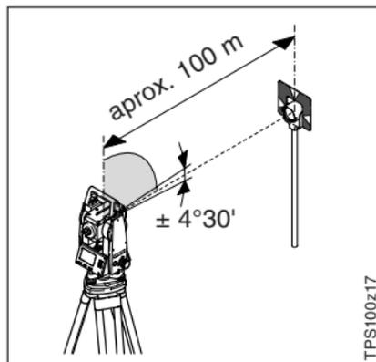
Para controlar la puntería horizontal se muestran en pantalla los ángulos Hz y V.
