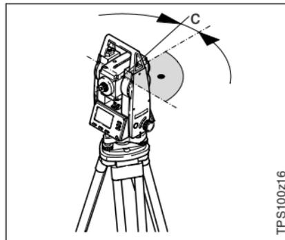
El error de colimación (C) es la desviación del ángulo recto formado por el eje de muñones y la línea visual. La influencia del error de colimación en el ángulo horizontal Hz aumenta con la altura sobre el horizonte. En visuales horizontales el error en Hz es igual al error de colimación.
