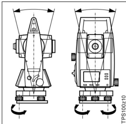
Cuando el nivel electrónico esté ajustado, estará nivelado el instrumento.
