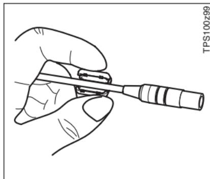
Antes de utilizar por primera vez el cable con un instrumento TCR110C, abra uno de los núcleos de ferrita y fíjelo alrededor del cable, muy próximo al enchufe Lemo (a unos 2cm de distancia del enchufe).
