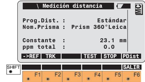
Se indica el programa de medición actual, el reflector elegido, la constante de adición (constante del prisma) actual y el valor ppm total.
