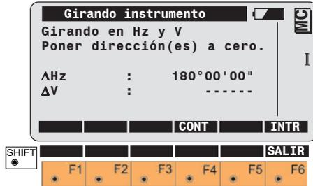
Girar el instrumento  $180^{\circ}$  (200 gon), de modo que  $\Delta Hz = 0^{\circ}00'00''$  (0.0000gon). Sobre la tecla **F5** aparece "OK".
