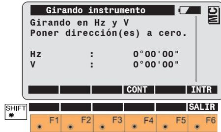
F5 Confirmar la disposición para la medición y cambiar al menú de medición.
