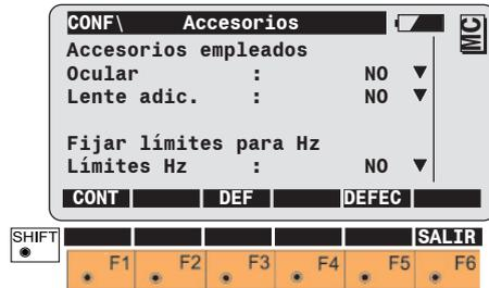
**F3** Fijar los límites para el movimiento del instrumento motorizado.
